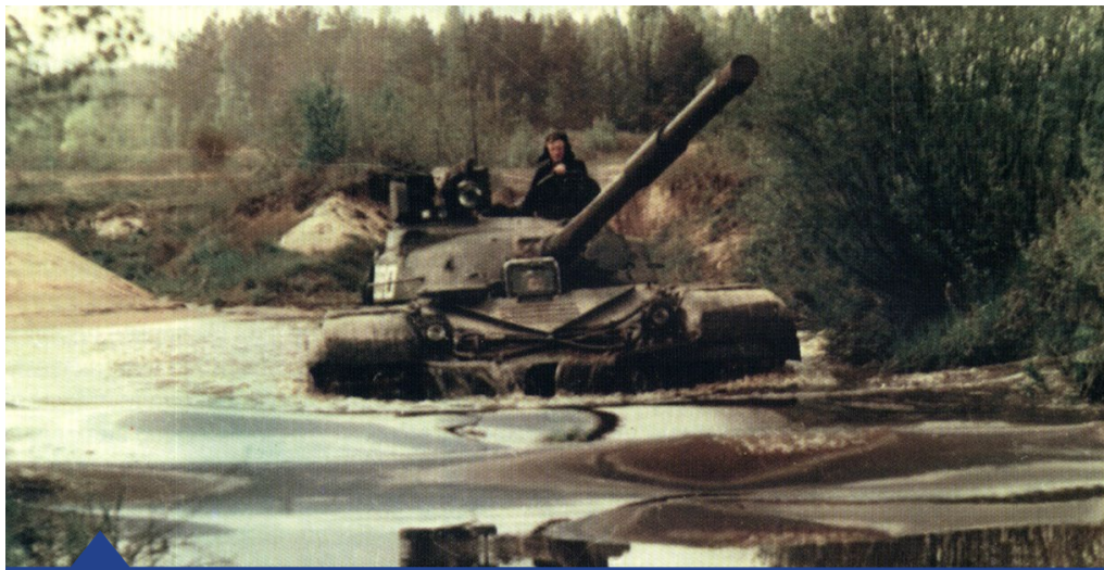
Танк Т-80 с двигателем ГТД-1000Т на испытаниях
